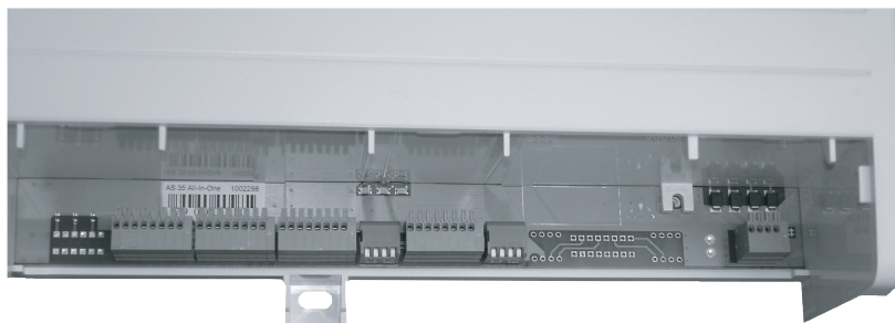
Geöffnetes Anschlussfeld der AS 35 All-In-One
