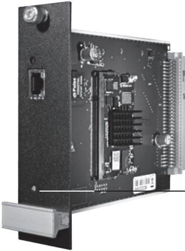
Das Modul IP-700 dient zur Erweiterung der IP-Sprachkanäle Ihres ES-Systems. Verbinden Sie die Netzwerkbuchse des Moduls mit Ihrem Netzwerk. Im Auslieferungszustand ist das Modul auf dynamische IP-Adress-Vergabe konfiguriert (DHCP-Client).
