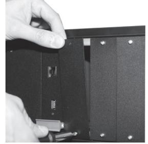
**ACHTUNG: Das Öffnen des Gehäuses darf nur durch eine Elektro-Fachkraft erfolgen. Sie benötigen dafür einen Kreuzschlitz-Schraubendreher Gr. 1.**
